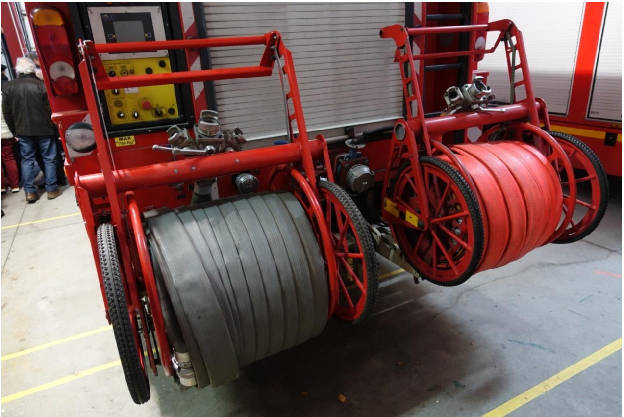
Véhicule FTP (Fourgon Pompe Tonne), les dévidoirs.
